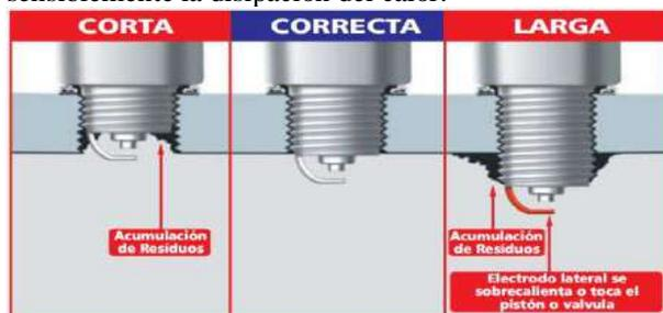
**Figura 1:** Diagrama Correcta posición de la bujía en los pistones.
